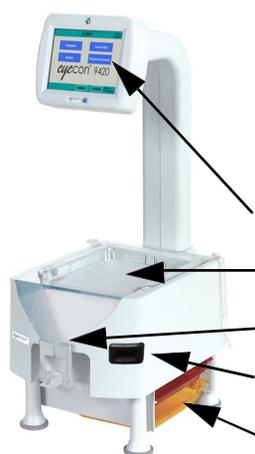
Eyecon utilise une caméra de haute technologie pour compter les pilules avec précision. Chaque médicament est associé à un DIN, un nom de médicament et une image enregistrée. Les photos du plateau de comptage sont saisies cinq fois par seconde et analysées pour déterminer le nombre de pilules sur le plateau.
